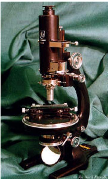
**Figura 4:** Modelo antiguo de microscopio de polarización
