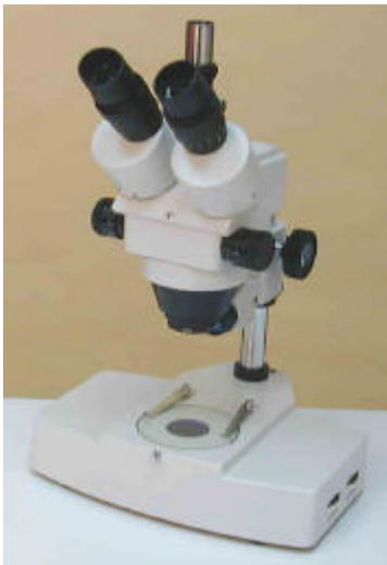
**Figure 17** Imagen de un estereomicroscopio.
